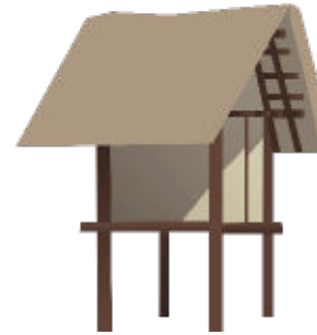
Un grenier sur 4 poteaux porteurs
