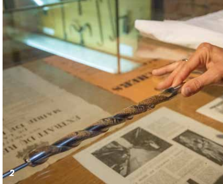
À l'intérieur du foret, parfois long de 40 centimètres, on aperçoit le prélèvement du bois qui vient d'être retiré de la poutre.
